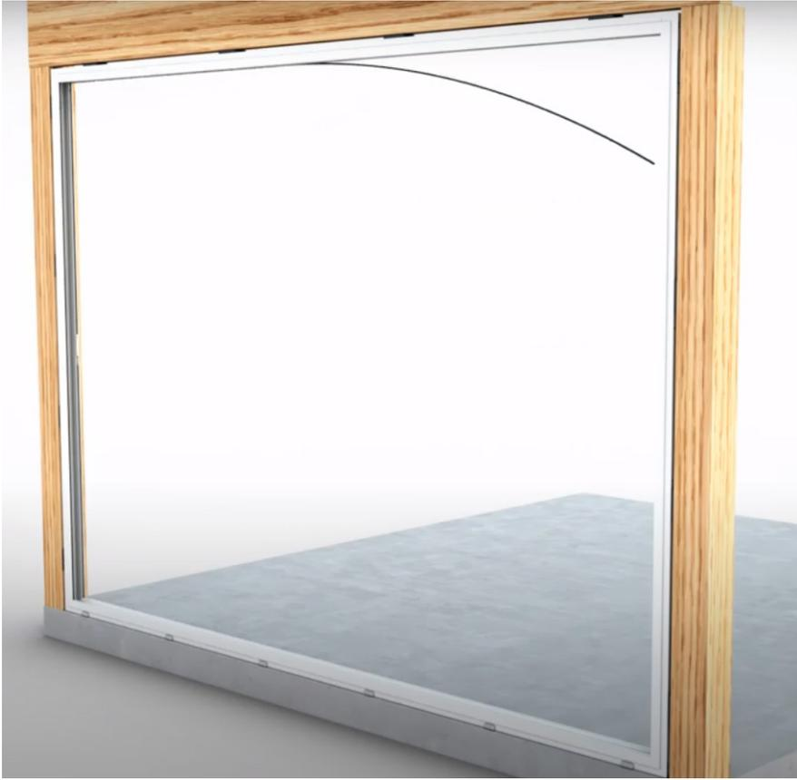
**13.1.** Heben Sie zuerst die Tür an, die sich in der innersten Schiene befinden soll.
